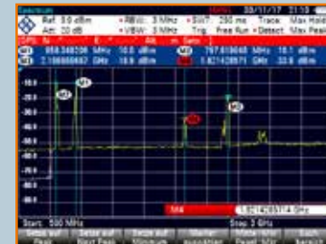
Messergebnis: Mobilfunk Basisstation in 200m Abstand
